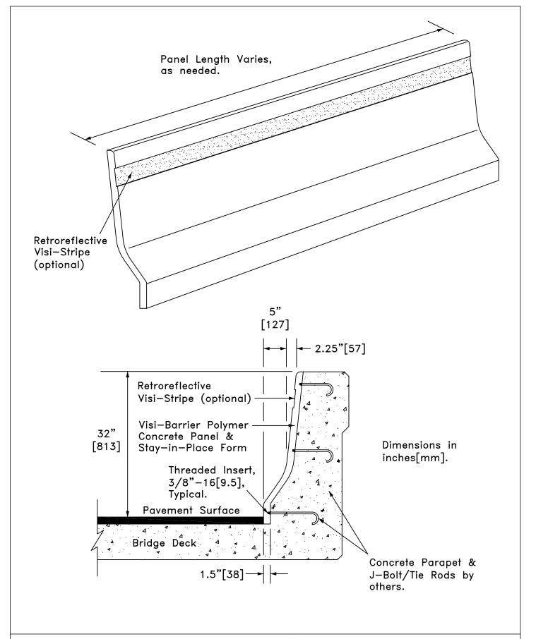
VISI-BARRIER, F-SHAPE, 32" HIGH BRIDGE RAILING
