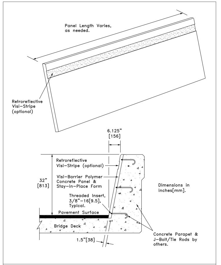
VISI-BARRIER, SINGLE-SLOPE, 32" HIGH BRIDGE RAILING
