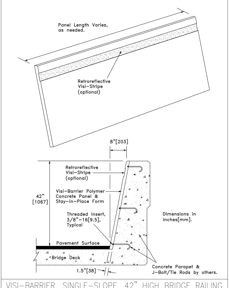
VISI-BARRIER, SINGLE-SLOPE, 42" HIGH BRIDGE RAILING
