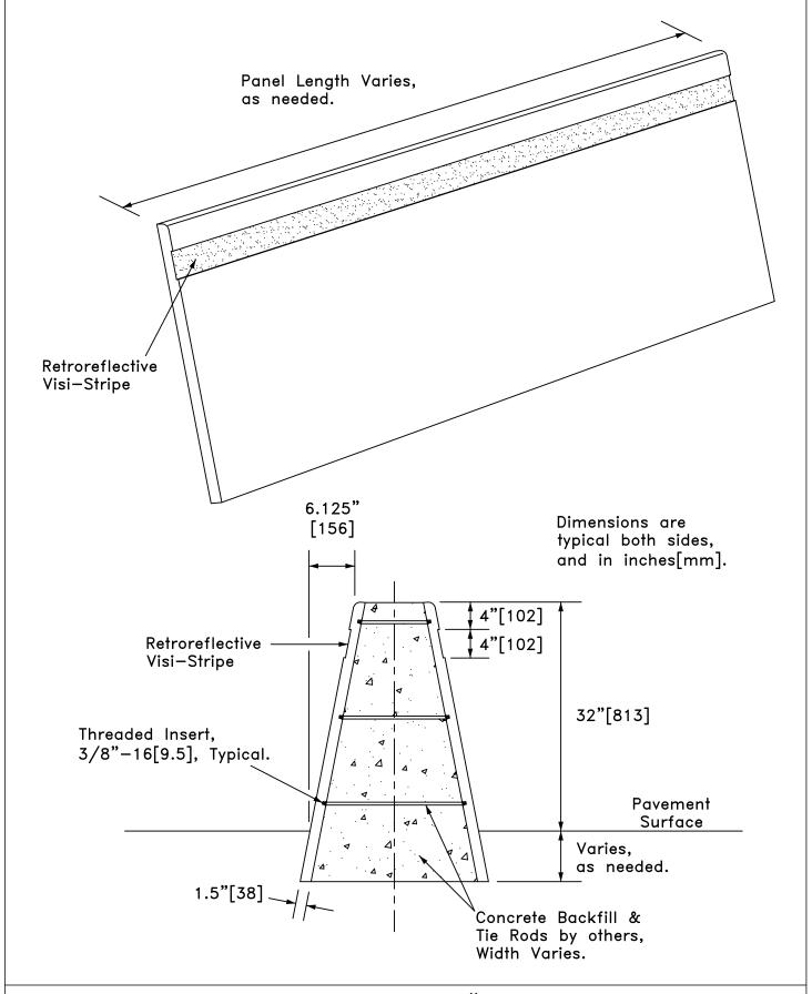
VISI-BARRIER, SINGLE-SLOPE, 32" HIGH MEDIAN BARRIER
