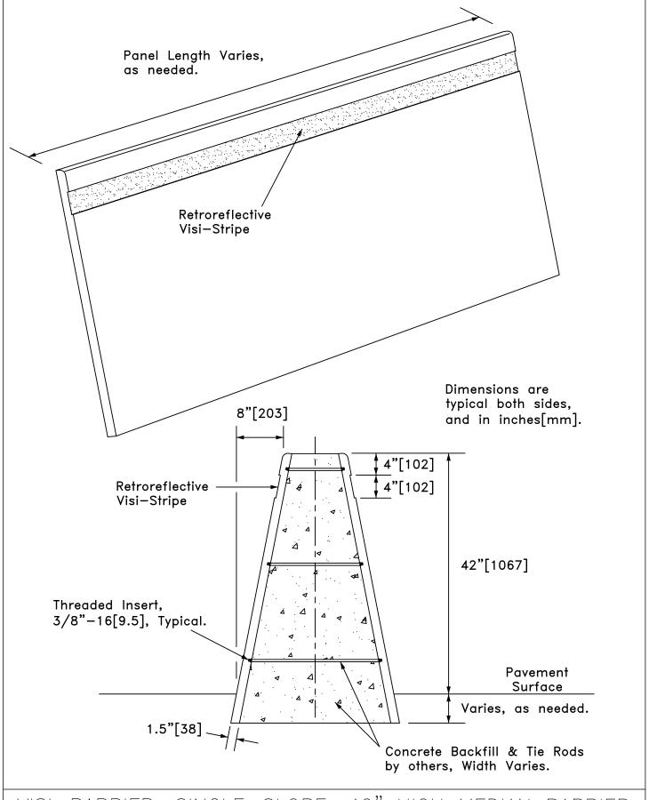
VISI-BARRIER, SINGLE-SLOPE, 42" HIGH MEDIAN BARRIER
