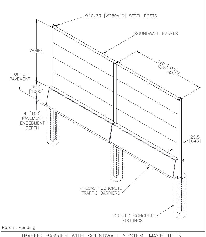
TRAFFIC BARRIER WITH SOUNDWALL SYSTEM, MASH TL-3
