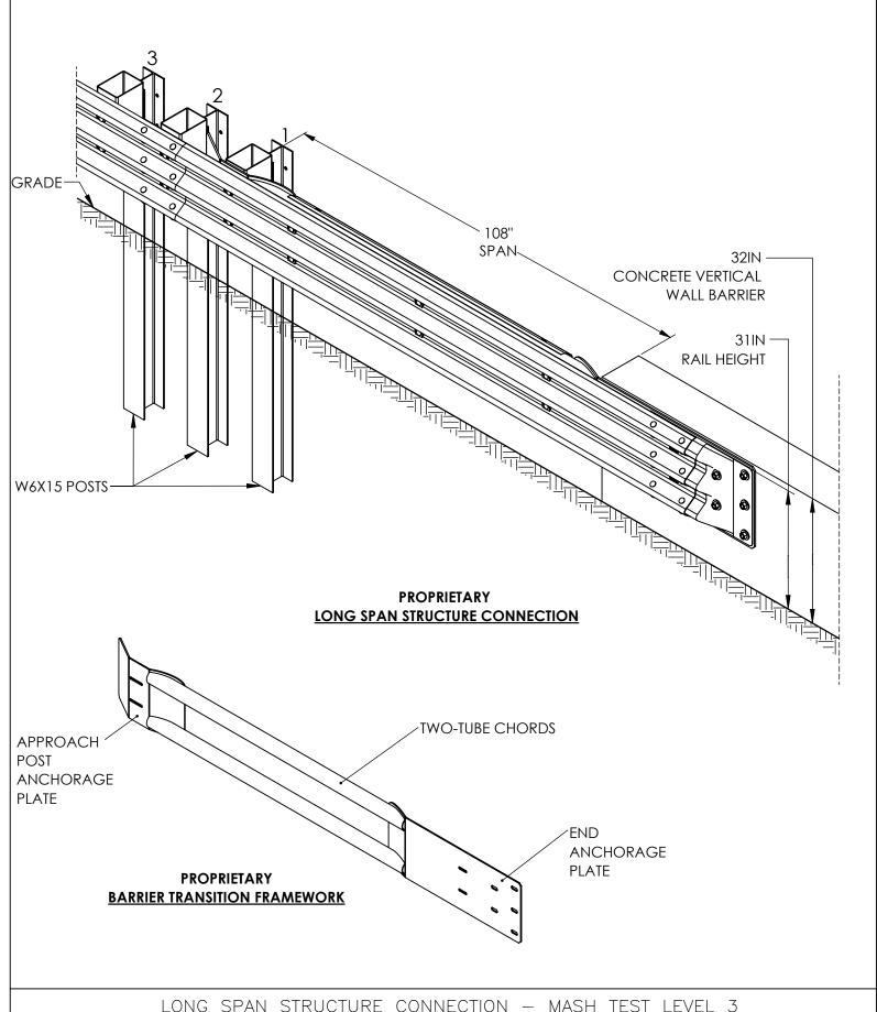
LONG SPAN STRUCTURE CONNECTION - MASH TEST LEVEL 3
